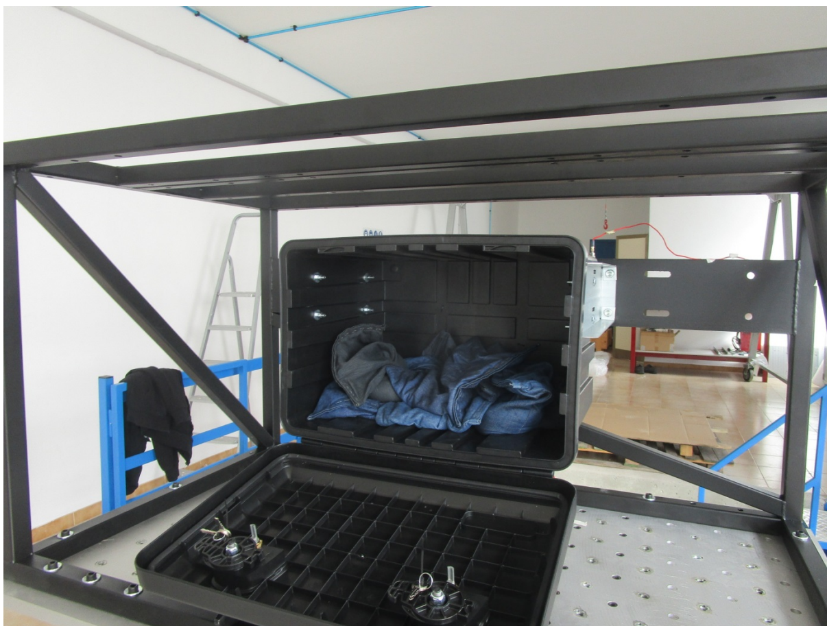
Immagine 4 - asse verticale - cassetta caricata con i sacchetti da 5 kg
