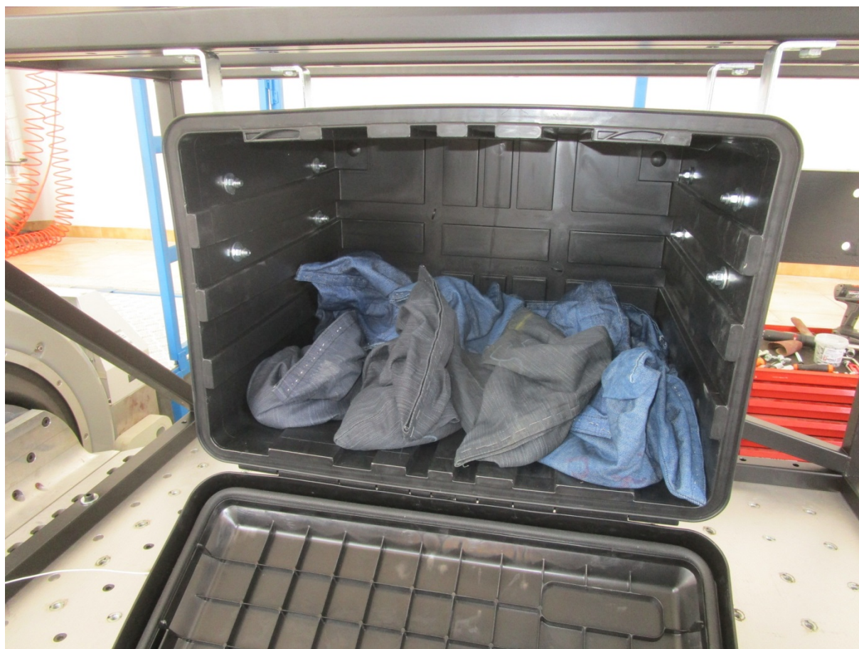
Immagine 7 - asse longitudinale - cassetta caricata con i sacchetti da 5 kg
